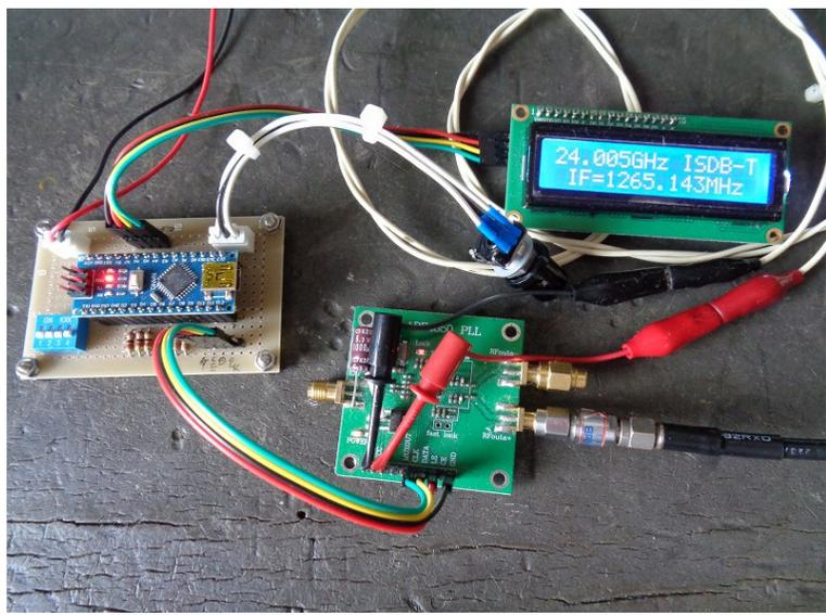
写真1. ArduinoでPLL\_LCD制御
