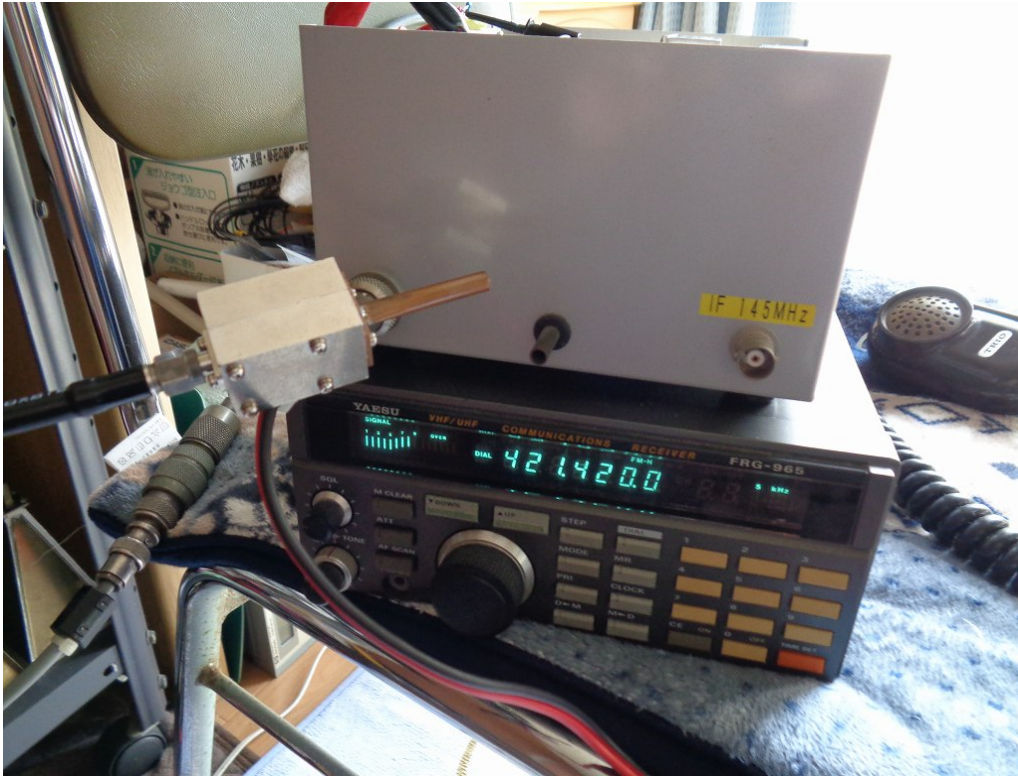
写真1. 47G TXと外部Mixerと FRG965で変調度調整中
